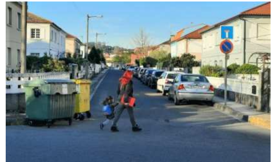
Foto 7.16 Intersección sin paso peatonal, sin rebajes de bordillo y con aceras muy estrechas
